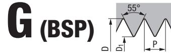
G (BSP) Whitworth-Rohrgewinde DIN EN ISO 228 Whitworth pipe thread DIN EN ISO 228
